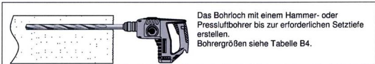
Das Bohrloch mit einem Hammer- oder Pressluftbohrer bis zur erforderlichen Setztiefe erstellen.
